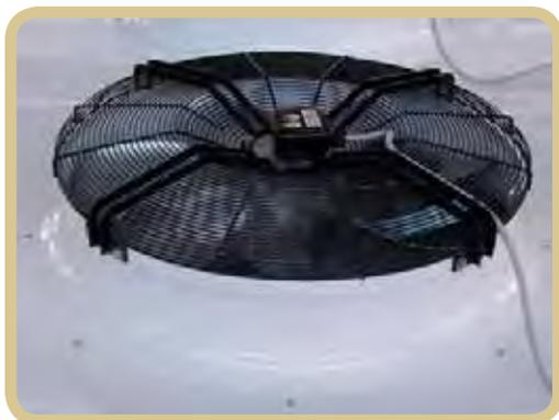
Centrali con condensatore a bordo di tipo Eco\_Noise ( carena insonorizzata e motoventilatori elettronici) modelli C3B \_\_\_\_ Z23E2
