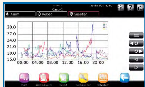
Podgląd rozkładu temperatury dostępny przez przeglądarkę internetową.
